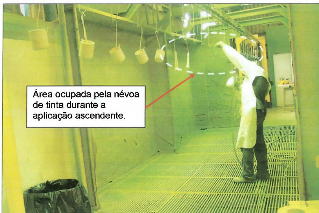
Figura 7 - Fotografia da aplicação de tinta em posição ascendente, com formação da névoa de tinta acima da cabeça do pintor.
